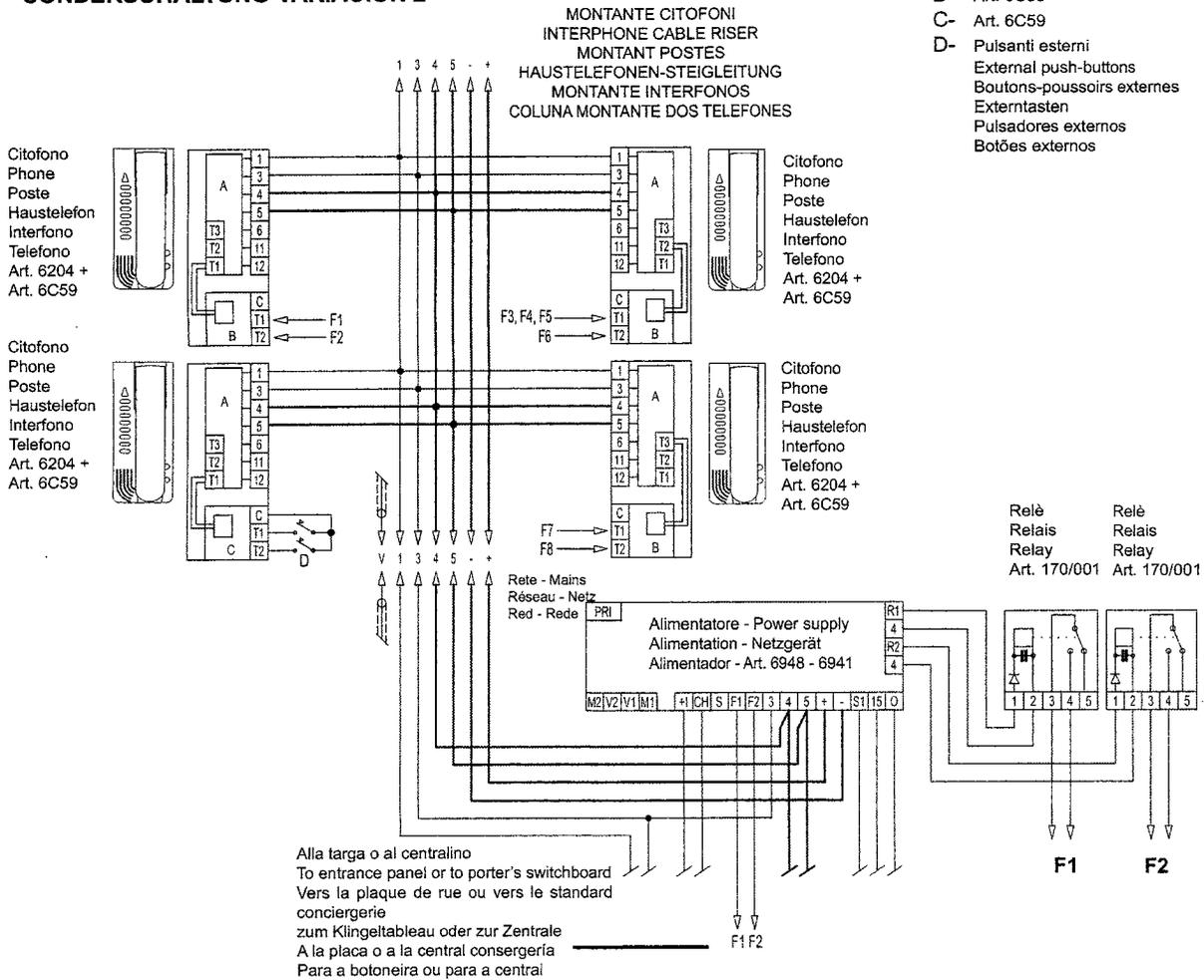
**Collegamento funzioni ausiliarie F1 - F2 in impianti videocitofonici muniti di decodifica interna.**
