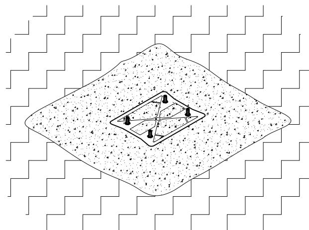
5) Dejado pasar un tiempo suficiente para que el cemento fragüe, se puede proceder a la instalación de la columna siguiendo las instrucciones que la acompañan, utilizando las 4 tuercas M8 DIN 985 y las 4 arandelas M8 DIN 125 para fijar la base de la columna.
