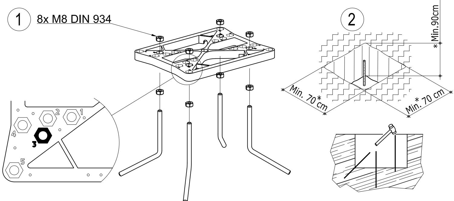
3) En el caso de llevar la alimentación eléctrica al interior de la columna desde la base inferior (solución ideal), este es el momento de enterrar también el tubo corrugado para el sucesivo cableado. Para mantener la posición del tubo, se le puede hacer pasar a través de las aperturas de la placa horizontal.
