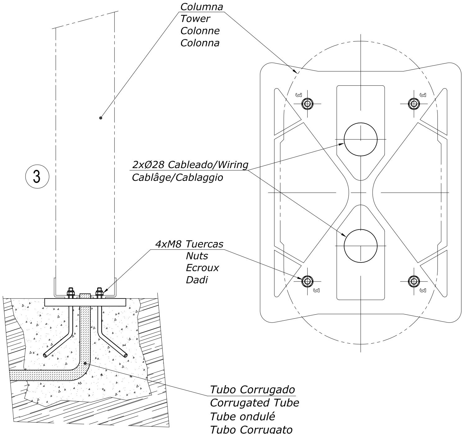
4) Verter el hormigón en el agujero realizado e insertar el accesorio (se recomienda proteger la parte roscada de la varilla con cinta adhesiva para evitar que el cemento se adhiera a las roscas). Tiene que quedar perfectamente horizontal (utilizar un nivel) y cementada hasta el nivel superior de la placa, solo tienen que sobresalir las 4 extremidades roscadas de las varillas.
