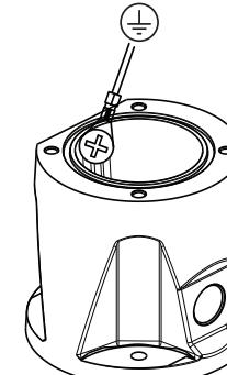
6. Atornille el cable GND verde de la base de la cámara en el orificio de conexión a tierra de la pared interior del DCA. Si el DCA no está montado a una superficie con conexión a tierra, conecte el cable de conexión a tierra (elemento 4 del paso 1) en el mismo punto de conexión.
