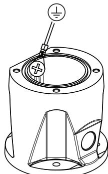
6. Coloque o fio verde de ligação à terra da base da câmara no orifício de ligação à terra existente na parede interior do DCA. Se o DCA não for montado numa superfície com ligação à terra, fixe o fio de ligação à terra fornecido pelo utilizador (item 4 do passo 1) no mesmo ponto de ligação.
