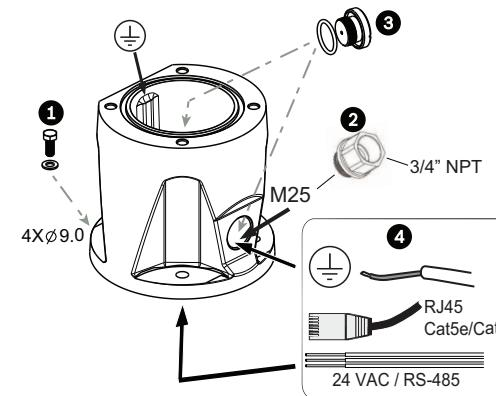
1. Collegare il DCA alla posizione di montaggio utilizzando l'hardware fornito dall'utente (elemento 1). Bosch consiglia di utilizzare bulloni e rondelle in acciaio inossidabile. Collegare il con-
