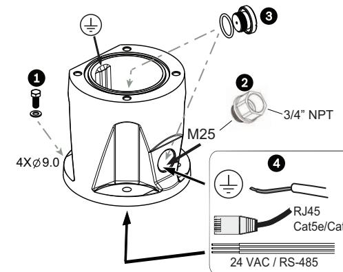
1. Bevestig de DCA op de montageplaats met bevestigingsmiddelen (onderdeel 1). (Bosch raadt het gebruik van roestvrijstalen bouten en ringen aan.) Breng doorvoeren of wartels aan in het gat aan de zijkant of onderkant. Gebruik, indien van toepassing, de meegeleverde kabeladapter (male M25 op female 3/4 inch) NPT) (onderdeel 2) indien nodig. Sluit het ongebruikte gat af (onderdeel 3). Voer kabels in de DCA (onderdeel 4).
