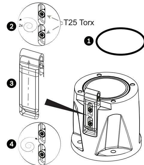
2. Isæt O-ring (emne 1). Løsn Torx-boltene med to (2) omdrejninger (emne 2). Skub hængslet op (emne 3). Spænd boltene for midlertidigt at holde hængslet i position (emne 4).
