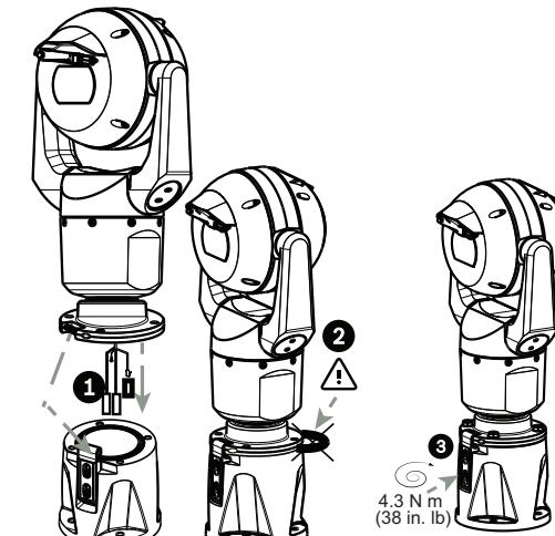
4. Coloque los cables en el DCA mientras se coloca el pasador de la base bajo el enganche (elemento 1). Evite pillar los cables (elemento 2).
