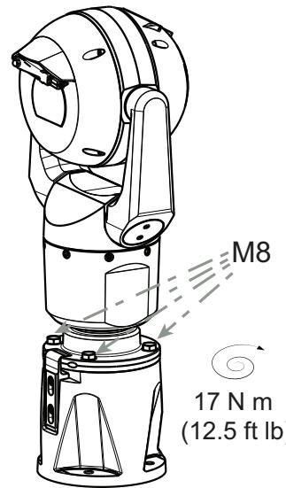
7. 小心地倾斜摄像机，使其进入最终位置。避免夹到摄像机底座与 DCA 之间的缆线！插入四个垫圈和六角螺栓（已提供）。
