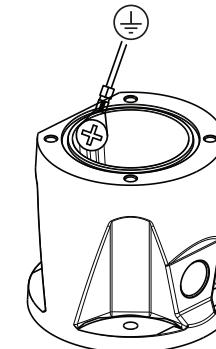
6. Skruva den gröna JORD-ledningen från kamerabasen till jordhålet på insidan av DCA väggen. Om DCA:n inte är monterad på jordad yta, fäst jordad ledning (del 4 i steg 1) på samma anslutningspunkt.
