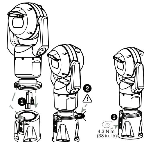
4. Placera ledningar i DCA:n när kamerans basstift placeras under kroken (del 1). Undvik att klämma ledningarna! (del 2). Skjut ned kroken för att säkra kamerastiftet. Dra åt krokbultarna helt (del 3).
