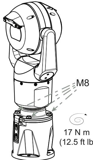
7. Mueva la cámara con cuidado hacia su posición final. Evite pillar los cables entre la base de la cámara y el DCA. Inserte cuatro arandelas y pernos hexagonales (incluidos).
