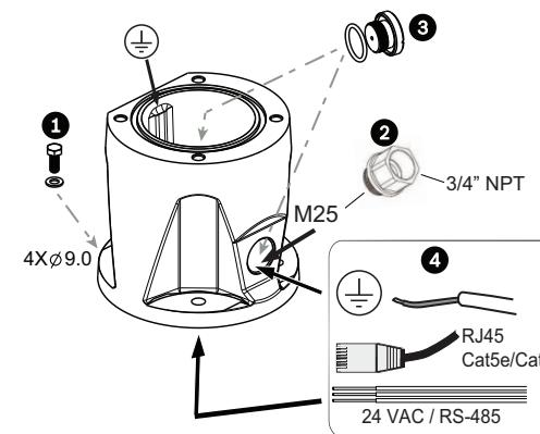
1. Sätt DCA på monteringsplatsen med hårdvara (del 1). (Bosch rekommenderar rostfria stålbultar och -brickor.) Sätt dit kabelrör eller boxar på sida- eller bottenhålet. Om tillämpligt, använd medföljande kabelrörssadaler (hane M25 till hona 3/4-tums NPT) (del 2) om nödvändigt. Plugga oanvänt hål (del 3). Dra kablar in i DCA (del 4).
