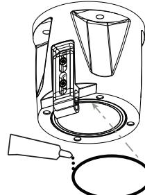
3. 对于倒置式安装，请将少量的油脂涂抹在主要的 O 形环上，以将其固定到位。
