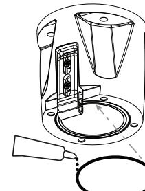
3. Tragen Sie für die hängende Montage eine geringe Menge Schmierfett auf den primären O-Ring auf, um ihn vorübergehend in seiner Position zu halten.
