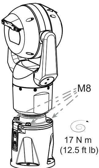
7. Placez délicatement la caméra sur sa position finale. Évitez de pincer les fils entre le socle de la caméra et l'adaptateur ! Insérez quatre rondelles et boulons hexagonaux (fournis).
