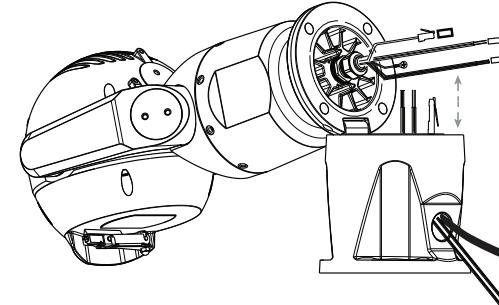
5. 小心地向某一侧倾斜摄像机，使摄像机销位于钩形装置下方。
