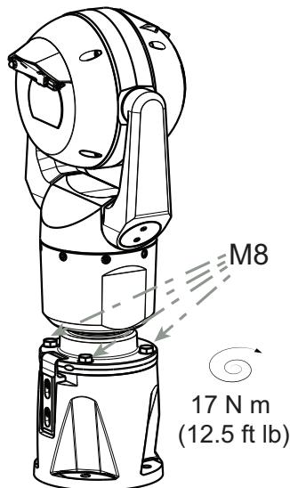
7. Capovolgere con cautela la telecamera in posizione finale. Non schiacciare i cavi tra la base della telecamera ed il DCA. Inserire le quattro rondelle ed i bulloni esagonali (in dotazione).
