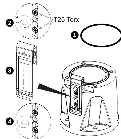
2. Inserte (elemento 1). Afloje los pernos Torx dos (2) vueltas (elemento 2). Deslice el enganche hacia arriba (elemento 3). Apriete los pernos para sujetar temporalmente el enganche en su sitio (elemento 4).
