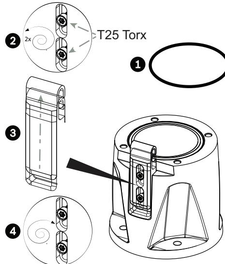
2. Legen Sie den O-Ring ein (Element 1). Lockern Sie die Torx-Schrauben um zwei (2) Umdrehungen (Element 2). Schieben Sie den Haken
