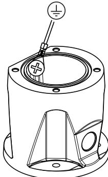
6. Verbinden Sie den Kamerafuß mithilfe des grünen Erdungskabels mit der Erdungsöffnung an der Innenseite des DCA-Adapters. Wenn der DCA-Adapter nicht auf einer geerdeten Oberflä-
