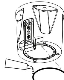
3. Para instalações na posição invertida, aplique uma pequena quantidade de massa lubrificante ao O-ring principal para o manter fixo.
