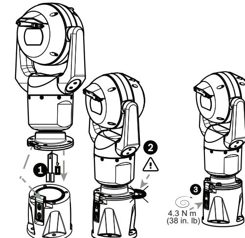
4. 将缆线放入 DCA，同时使摄像机的座销位于钩形装置下方（项目 1）。避免夹到缆线！（项目 2）。将钩形装置向下滑，以固定摄像机销。完全拧紧钩头螺栓（项目 3）。
