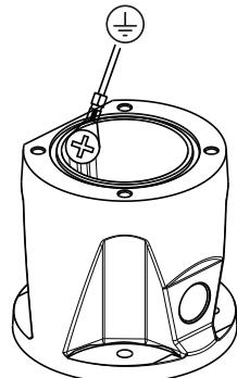
6. Vissez le fil de masse vert du socle de la caméra sur l'orifice de la prise de terre à l'intérieur de l'adaptateur pour gaine large. Si l'adaptateur pour gaine large n'est pas monté en surface, fixez le fil de terre fourni par l'utilisateur (élément 4 de l'étape 1) sur le même point de connexion.
