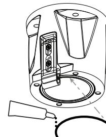
3. Per l'installazione in posizione capovolta, applicare una piccola quantità di grasso sull'O-ring principale, in modo da bloccarlo in posizione.
