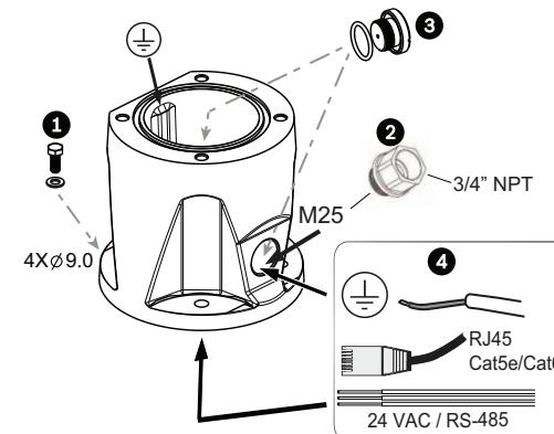
1. Fixe o DCA no local de montagem utilizando o hardware fornecido pelo utilizador (item 1). (A Bosch recomenda parafusos e anilhas em aço inoxidável.) Fixe a cablagem ou os buçins fornecido pelo utilizador no orifício lateral ou
