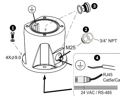
1. Conecte el DCA a la ubicación de montaje usando la tornillería (elemento 1). (Bosch recomienda utilizar pernos y arandelas de acero inoxidable). Conecte el conducto o casquillos en el orificio lateral o inferior. Si fuera necesario, utilice el adaptador de conductos suministrado (macho M25 a hembra de 3/4 pulg. NPT) (elemento
