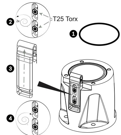
2. Sätt in (del 1). Lossa Torxbultarna två (2) varv (del 2). Skjut upp kroken (del 3). Dra fast bultarna för att hålla fast kroken tillfälligt (del 4).
