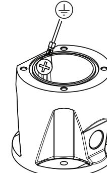
6. Skru det grønne GND-kabel på kamerasoklen i bundhullet på indersiden af DCA'en. Hvis DCA'en ikke er forbundet med en jordforbundet overflade, skal det Brugerleveret jordkabel (emne 4 i trin 1) forbindes til samme tilslutningspunkt.
