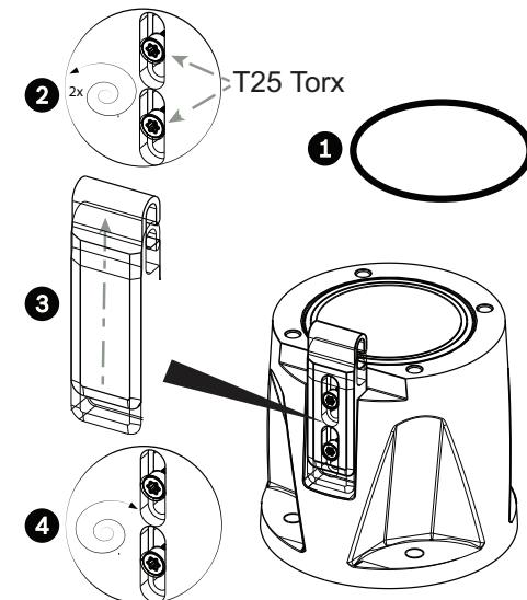
2. 插入 O 形环（项目 1）。旋转两（2）圈，将 Torx 螺栓拧松（项目 2）。向上滑动钩形装置（项目 3）。拧紧螺栓以将钩形装置暂时固定到位（项目 4）。
