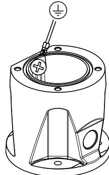
6. Collegare il cavo di messa a terra (GND) verde dalla base della telecamera al foro per la messa a terra, sulla parete interna del DCA. Se il DCA non è montato su una superficie con messa a terra, collegare il cavo di messa a terra fornito dall'utente (elemento 4, punto 1) allo stesso punto di collegamento.
