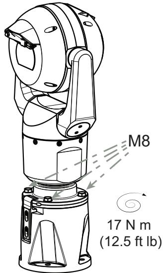
7. Aseta kamera varovasti lopulliseen asentoonsa. Varmista, että johdot eivät joudu puristuksiin kameran jalustan ja DCA:n väliin! Aseta neljä aluslevyä ja kuusipulttia (toimitettu).
