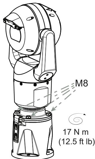
7. Coloque cuidadosamente a câmara na respectiva posição final. Evite entalar os fios entre a base da câmara e o DCA! Introduza quatro anilhas e parafusos de cabeça sextavada (fornecidos).
