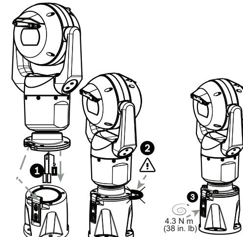
4. Wsunąć przewody do głębokiego przepustu kablowego, jednocześnie umieszczając zatrzask podstawy kamery pod hakiem (element 1). Należy uważać, aby nie ścisnąć kabli! (element 2).
