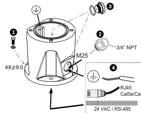
1. Kiinnitä DCA asennuspaihkaan kiinnitystarvikkeilla (käyttäjän toimittama) (kohde 1). (Bosch suosittelee käytettäväksi ruostumattomasta teräksestä valmistettuja pultteja ja aluslevyjä). Kiinnitä kanava tai holkit (käyttäjän toimittama) sivu- tai alareikään. Käytä tarvittaessa mukana toimitettua kanavasovitinta (urospuolinen M25 naaraspuoliseen 3/4 tuuman
