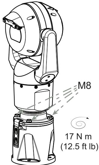
7. Ostrożnie obrócić kamerę do ostatecznego położenia. Należy uważać, aby nie ścisnąć kabli między podstawą kamery i głębokim przepustem kablowym! Przykręcić cztery śruby z łączem sześciokątnym i podkładki (w zestawie).
