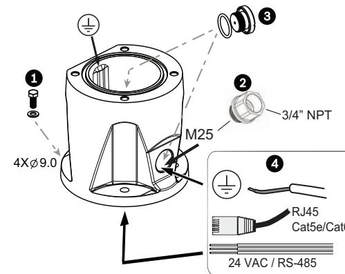
1. 使用用户提供硬件（项目 1），将 DCA 连接到安装位置。（博世建议采用不锈钢螺栓和垫圈。）将用户提供导管或密封套连接到侧面或底部的孔。如果适用，请在需要时使用提供的导管适配器（凸型 M25 至凹型 3/4 英寸 NPT）（项目 2）。塞住不使用的孔（项目 3）。将电缆连接到 DCA（项目 4）。
