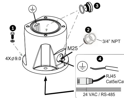
1. Przymocować głęboki przepust kablowy w miejscu montażu za pomocą osprzętu (element 1). (Firma Bosch zaleca stosowanie śrub i podkładek ze stali nierdzewnej.) Przymocować przepust do otworu z boku lub na dole. W stosowanych przypadkach użyć dołączonego do zestawu adaptera przepustu kablowego (NPT męski M25 na żeński 3/4") (element 2). Zaślepić niewyko-
