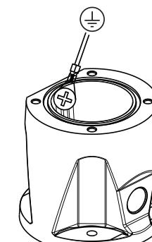
6. Schroef groene GND-draad van camerasokkel aan aardingsopening in binnenwand van DCA. Als DCA niet wordt gemonteerd op geaard oppervlak, bevestig dan geaarde draad (onderdeel 4 in stap 1) aan hetzelfde aansluitpunt.
