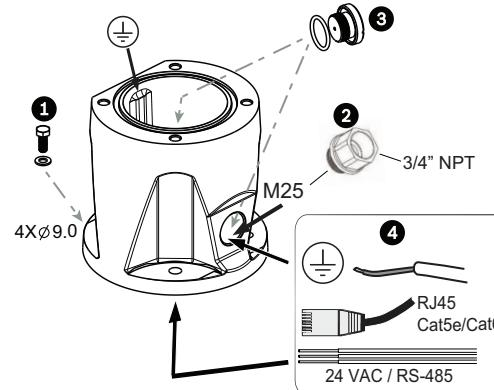
1. Bringen Sie den DCA-Adapter mithilfe der kundenseitig bereitgestellten Hardware am Befestigungsstandort an (Element 1). (Bosch empfiehlt Edelstahl-Schrauben und -Unterlegscheiben.)
