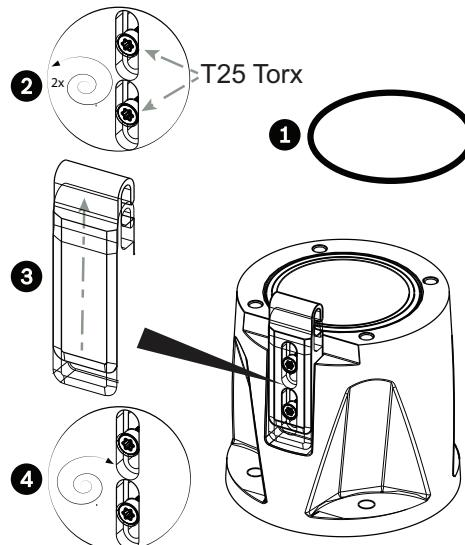
2. Insira o O-ring (item 1). Desaperte os parafusos Torx duas (2) voltas (item 2). Faça deslizar o gancho para cima (item 3). Aperte os parafusos para manter o gancho fixo de modo temporário (item 4).
