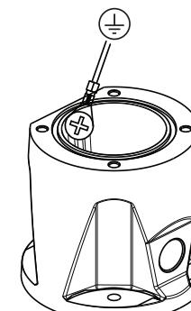
6. Przykręcić zielony przewód masy do podstawy kamery i otwór styku masy na wewnętrznej ścianie głębokiego przepustu kablowego. Jeśli głęboki przepust kablowy nie został zamontowany na uziemionej powierzchni, przymocować przewód masy (element 4 w kroku 1) do tego samego punktu połączenia.
