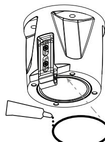
3. For en omvendt installation påføres lidt smøremiddel på den primære O-ring for at holde den i position.
