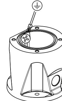
6. 用螺丝固定从摄像机底座到 DCA 内壁上接地孔的绿色接地缆线。如果您尚未将 DCA 安装到接地表面，则将用户提供接地缆线（步骤 1 中的项目 4）连接到同一个连接点。
