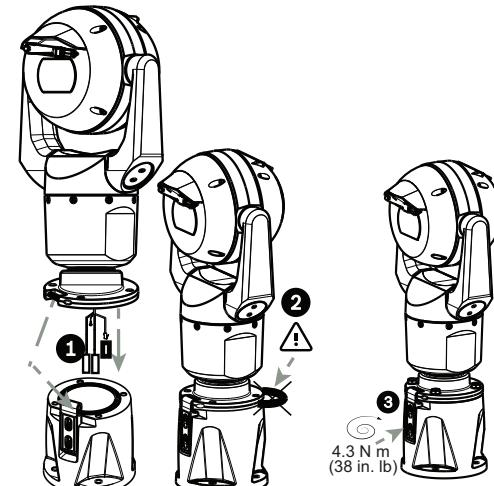
4. Führen Sie die Kabel in den DCA-Adapter ein, während Sie den Bolzen für den Sockel der Kamera unterhalb des Hakenverschlusses anbringen (Element 1). Gehen Sie dabei vorsichtig vor, um keine Kabel einzuklemmen! (Element 2).
