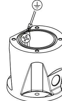
6. Ruuva kameran jalustan vihreä maadoitusjohto DCA:n sisäseinämän maadoitusreikään. Jos DCA:ta ei ole asennettu maadoitetulle pinnalle, kiinnitä käyttäjän toimittama maajohto (kohde 4 vaiheessa 1) samaan kytktäkohtaan.
