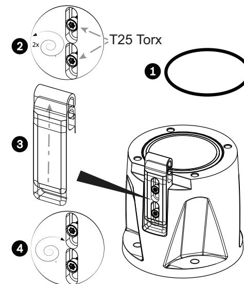
2. Wsunąć pierścień (element 1). Poluzować śrubę typu Torx o dwa (2) obroty (element 2). Przesunąć hak do góry (element 3). Dokręcić śrubę, aby tymczasowo przytrzymała hak (element 4).
