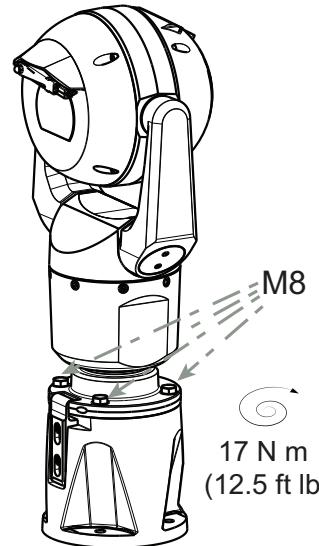
7. Luta kameran försiktigt i slutligt läge. Undvik att klämma ledningarna mellan kameran och DCA:n! Sätt in fyra brickor och insexbultar (medföljer).
